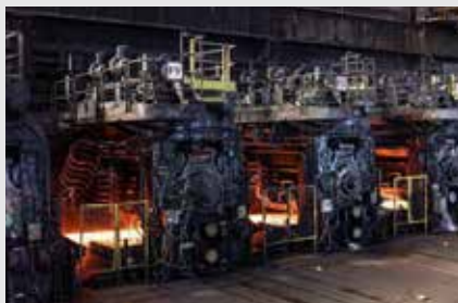
Les cages de laminage du train à chaud
