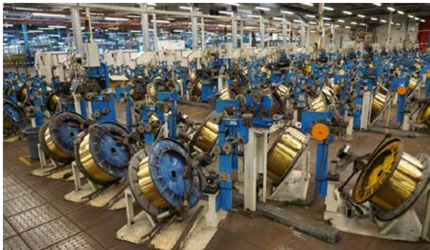
Retordage des bobines de fils métalliques
