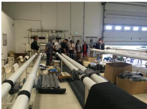
Dans une autre partie de l'atelier a lieu la préparation de tout l'accastillage du bateau et en particulier du mat et de la bôme. Ceux-ci sont le fruit d'une longue expérience d'AMEL. La grand-voile s'enroule dans le mat, ce qui facilite la prise de ris en cas de mauvais temps. Idem pour le foc qui possède son propre enrouleur.
